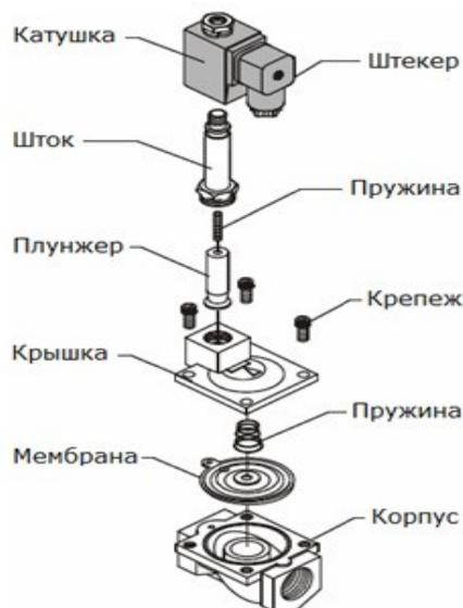
Рисунок 1.2 – Устройство электромагнитного клапана
