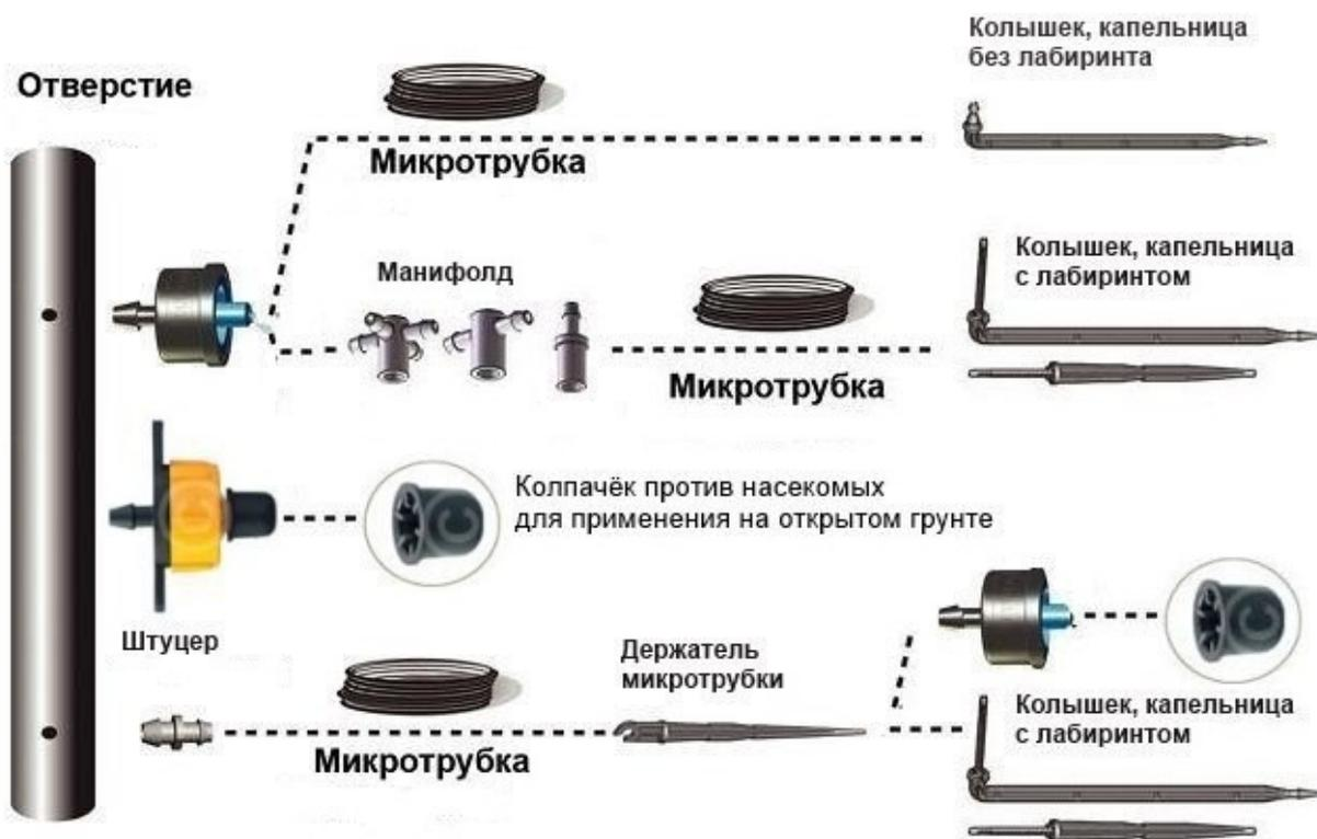
Рисунок 1.3 – Виды и монтаж капельниц для полива
